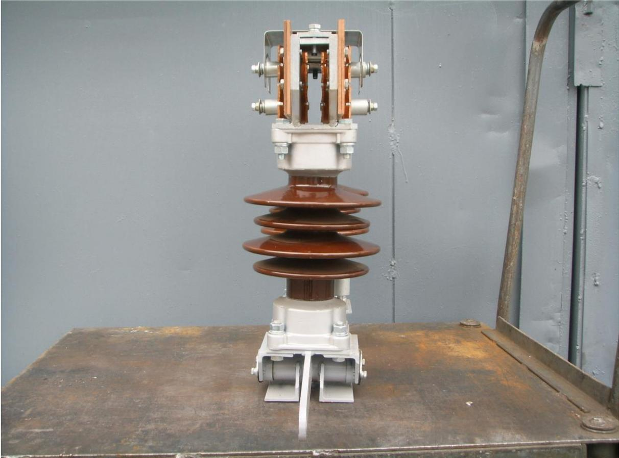
**Приложение 2** Вид на технический объект (разъединитель) с кожухом слева (контакты замкнуты)
